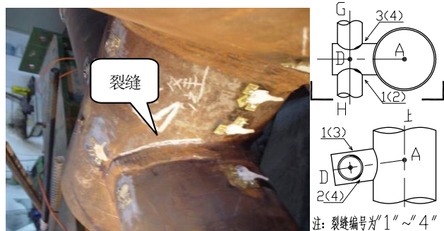
图8 底部节点 HB2 破坏照片与示意图
